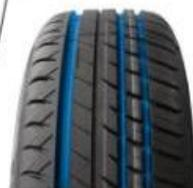
Технология Hydro Safe S – три широкие продольные канавки эффективно выводят воду из пятна контакта. Самая широкая канавка расположена с внешней стороны, что обеспечивает высокую устойчивость в поворотах на мокрой поверхности
