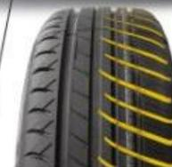
Скоростные отводящие канавки с повышенной эластичностью на внутренней стороне протектора – для улучшения сопротивления аквапланированию и повышения комфорта движения
