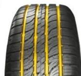
Технология Hydro Safe S – четыре широкие продольные канавки, имеющие неоднородную геометрию и заостренные грани центральных шашек, более эффективно разбивают водную пленку, обеспечивая оптимальный отвод жидкости из пятна контакта
