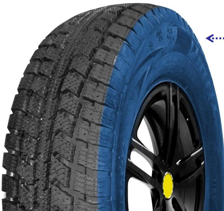
Технология VRF (Variable rigidity of a framework)-переменная жесткость боковины – меняется при изменении скорости – шина адаптируется под дорожное покрытие и позволяет проходить повороты на более высокой скорости, а при движении по плохому покрытию смягчает удары при наезде на ямы и стыки асфальта.
