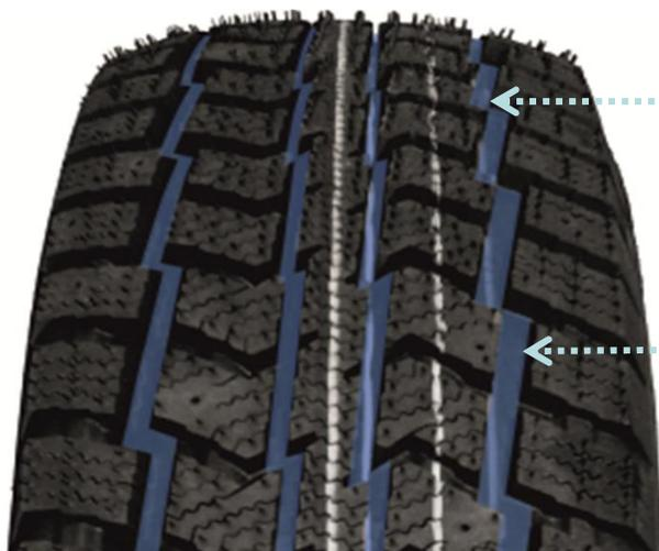
Технология Hydro Safe S – четыре широкие продольные канавки, имеющие неоднородную геометрию и заостренные грани центральных шашек, более эффективно разрезают слякоть, снежная каша быстрее вытесняется из пятна контакта шины с дорогой.
