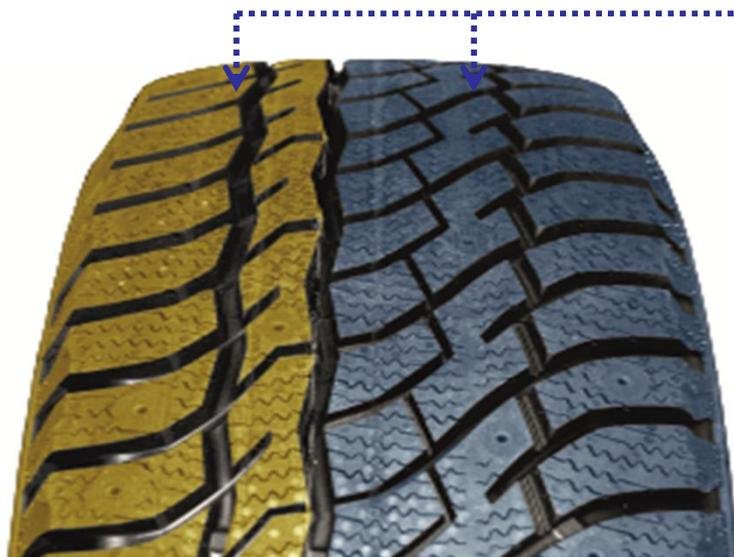
Асимметричный рисунок протектора Bosco Nordico с увеличенным количеством шашек и широко разнесенная ошиповка обеспечивает наилучшее сцепление, и износостойкость и снижают уровень шума.
