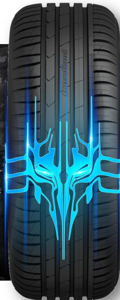
Cordiant Sport 3 стабильно ведет себя на мокрой дороге, благодаря улучшенной дренажной системе **WET-COR®**. Канавки во внутренней и внешней плечевых зонах, способствуют отводу воды и повышают сцепление при большом количестве воды на трассе.
