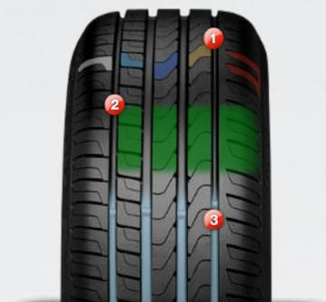
**1** Оптимизированный рисунок протектора с неравномерным шагом блоков
